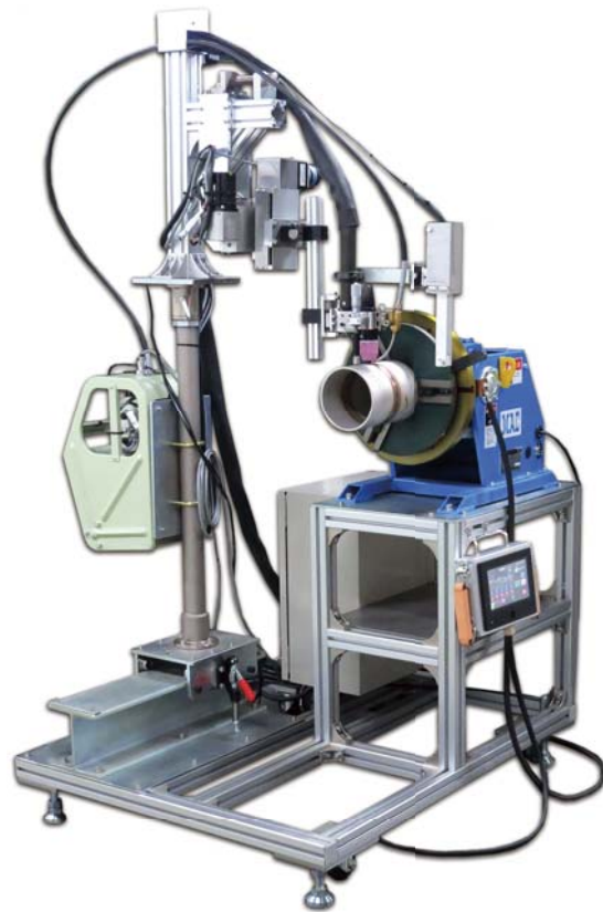
簡易パイプ溶接装置
