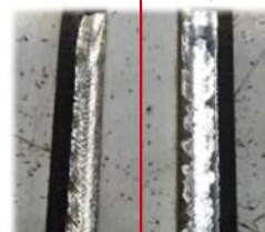
ロボット自動スラグ除去後
