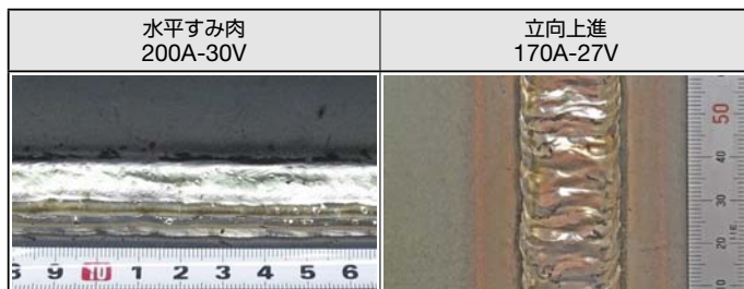
写真1 FC-9NIの溶接ビード外観
