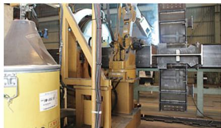
柱大組立溶接ロボットにYM-55C(R)を採用
