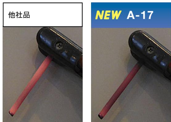
写真4 A-17の耐棒焼け試験状況 (溶接終了直後(残棒100mm))
