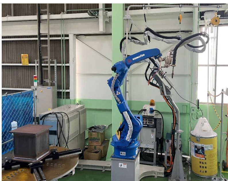
コマツ製『RAL20』と日鉄溶接工業製『SX ワイヤ』
