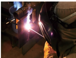
開先形状:板厚9mm、開先角度30°、RF1mm、RG2.3mm 溶接姿勢:立向上進、棒径:3.2mm、棒長:400mm
