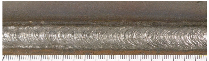
棒径: 4.0mm 溶接姿勢: 水平すみ肉 溶接電流: 160A
