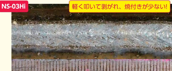
サイズ: 3.2mm 溶接姿勢: 水平すみ内 溶接電流: 140A
