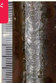
棒径：3.2mm、溶接電流：100A、溶接姿勢：立向上進
