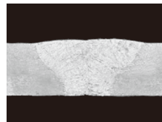
I形突合せ (材質:SS、板厚:3.2mm)
