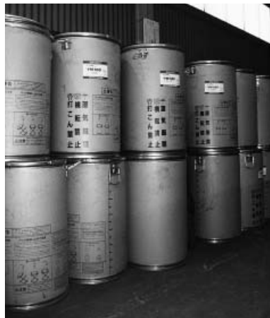
採用頂いている◎YM-55Sの250キロストレートパック (ワイヤ径1.6ミリ)
