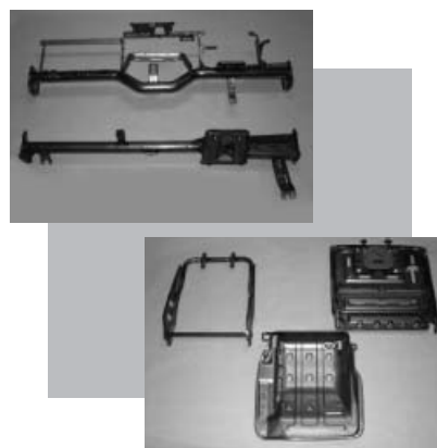
第一生産事業部で製造されている自動車部材の代表例 (上・ステアリングサポート、下・シートフレーム)
