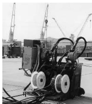
常石工場で4台採用されているNS-ワンサイドマグ（2電極揺動式下向CO 2 片面溶接機）。先行ワイヤに◆YM-55H、後行ワイヤに◆SF-1、カットワイヤに◆YK-CMが採用されている。
