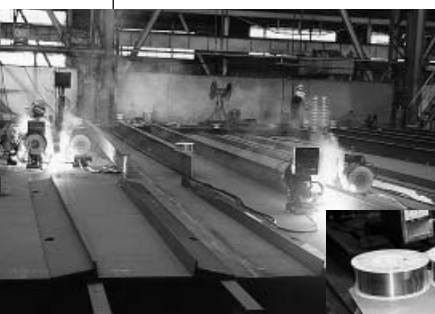
簡易自走台車によるロンジ材のすみ肉溶接には◆SM-1F（ワイヤ径1.2mm）が採用されている。
