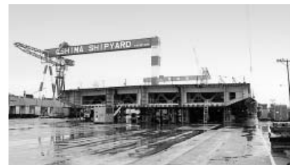
同社は造船の他、橋梁も手がけている。写真は塗装・仮組を終えて出荷を待つばかりの長崎市女神(めがみ)大橋向け部材
