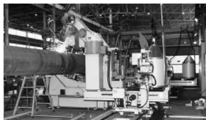
梁加工ライン。設備を固定し、製品を移動させる方式で対応している
