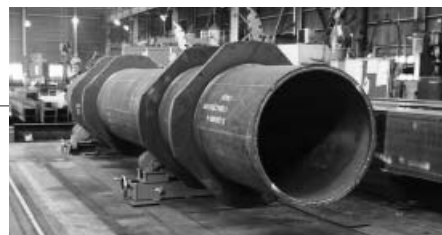
リングの溶接を終えた丸パイプ材
