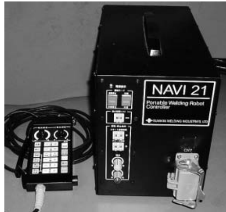
操作ペンダントと制御装置
