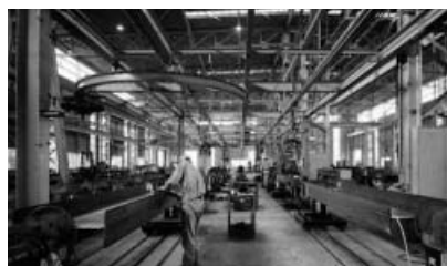
梁加工ライン。設備を固定し、製品を移動させる方式で対応している
