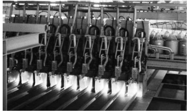
写真2 ツインタンデム水平すみ肉ガスシールドアーク溶接法(HS-MAG法)のパネルラインへの適用例
