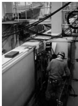
写真3 2電極VEGA溶接のコンテナ船シャーストレキ部への適用例
