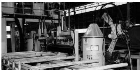
◆SF-1の200kgストレートバック(ワイヤ径1.2mm)がパイプフランジ・スリーブ用溶接ロボットに採用され、溶接の効率化に寄与している
