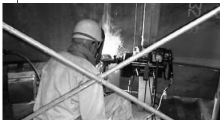
日鐵住金溶接工業製の多目的溶接ロボット「NAVI-21」が造船ブロックの立向き溶接に採用されている(溶材:◆AS-1V、ワイヤ径1.2mm)
