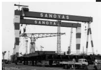
高効率の船づくりを支える2基のゴライアスクリーン(各240トン能力)
