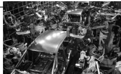
自動車製造ラインの溶接工程はロボット化されており、溶材には高精度、高品質、溶接安定性などが求められている。当社製品では◎YMブランドを中心に採用いただいている。
