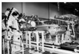
ロボットを用いたフレキシブルボディ自動溶接ラインの例
