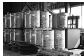
メインの銘柄として、◎YM-55Cのストレートパック(ワイヤ径1.2mm)が採用されている
