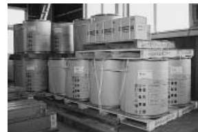
ロボット溶接用の溶材には◎YM-28Sのストレートバック(ワイヤ径1.4mm,350kg)を採用いただいている
