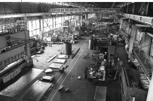
石狩事業所工場内部。幅7mまで可能な600t能力プレス機、10t能力の天井クレーンなどが装備されており大型構造物が可能という特色をもっている
