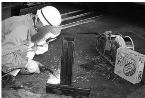
◎YM-28(エコ)による溶接作業中の横田氏。溶接歴約40年に及ぶベテラン
