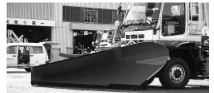
スノーブラウは除雪車に写真のように取り付けられる
