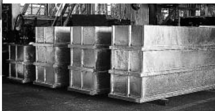
埠頭のクレーン転倒防止部材として基礎部分に埋め込まれる重量部材。表面に亜鉛めっきが施されている
