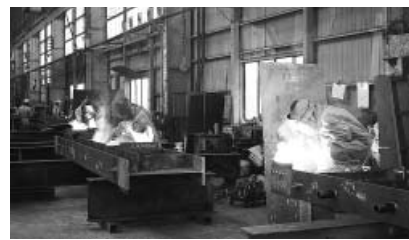
◎SF-1による溶接作業状況。◎SF-1に加えて◎SF-1(エコ)もすでに導入され始めており、受注物件によって適用頂いている
