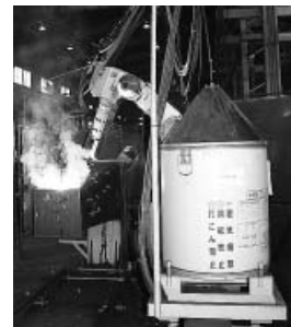
メインの溶材としてSCH-55のストレートバック（ワイヤ径1.2mm、400kg）が採用され、溶接の高効率化に貢献している
