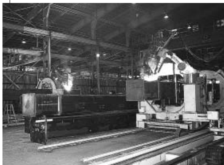
ロボット溶接状況
