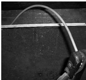
写真1 溶接棒を曲げての溶接(3.2mm)
