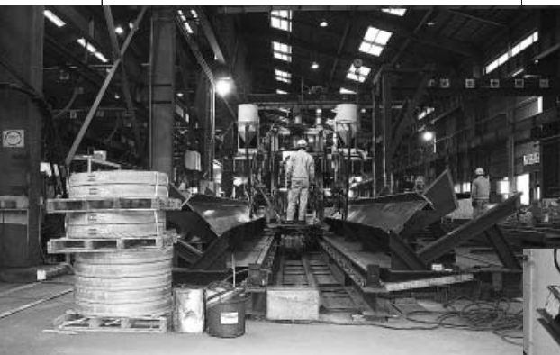
某機械メーカーとの共同開発によるガルウイングタイプのサブマージアーク溶接機。すでに特許出願中で3台設置されている。部材を固定させ、溶接台車を移動させてワンパスで両サイドの溶接をこなす方式となっている。溶材としてW-36L(銘柄統合後は☉Y-DL)、フラックスとしてBF-25(同☉NF-900S)が採用されている(ワイヤ径は4.8mm)
