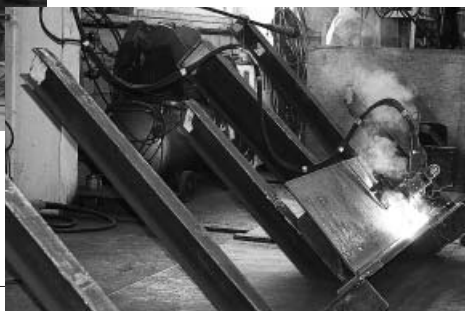
某機械メーカーとの共同開発によるガルウイングタイプのサブマージアーク溶接機。すでに特許出願中で3台設置されている。部材を固定させ、溶接台車を移動させてワンパスで両サイドの溶接をこなす方式となっている。溶材としてW-36L(銘柄統合後は☉Y-DL)、フラックスとしてBF-25(同☉NF-900S)が採用されている(ワイヤ径は4.8mm)
