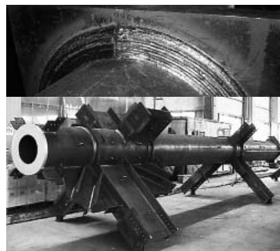
超極厚遠心鑄造鋼管を使用したCFTの加工状況（上はリング溶接部の外観）
