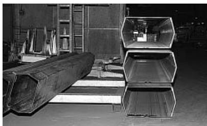
溶接を終えたブーム部材。曲げ加工された鋼板を、同社独自開発によるオートウェルダ装置で溶接し、強度に優れた六角形の断面ボックスに仕上げている
