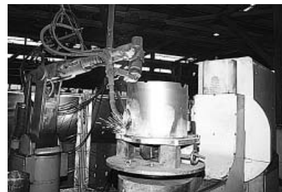
ベース部材の溶接状況。ロボット溶接が採用されており、溶材として◎YM-SCZ(ワイヤ径1.2mm)が採用されている
