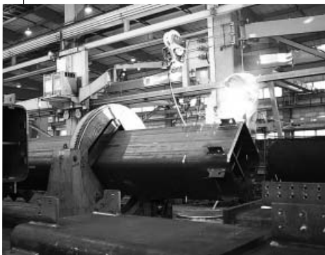
写真に見られる半自動溶接には、「ユニゴン」と命名されている同社独自開発の半自動溶接装置が幅広く活躍している。工場では20台（半自動溶接機40台）が稼働している。溶材にはロボット溶接を含め、◎YM-26のスパール、ストレートバックが大々的に採用されている（ワイヤ径は大半が1.2mm）
