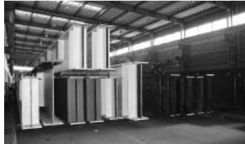
2年前に増築された屋根付き製品置き場。出荷を控えた大型鉄骨部材が立ち並ぶ
