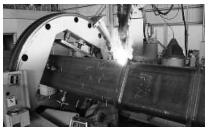
最大800ミリ角、板厚40ミリまでが可能な柱大組溶接ロボット。 ◎YM-55Cの350キロパック(ワイヤ径1.2ミリ)が採用されている
