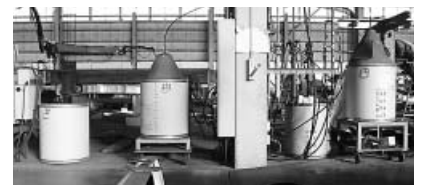
泉沢工場の半自動溶接ではアルゴン混合ガス溶接が進められており、◎YM-55AGSが採用され品質向上に貢献している
