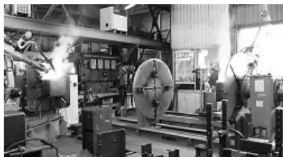
コア連結溶接ロボットには◎YM-55C(ワイヤ径1.2ミリ、250キロパック)が採用されている
