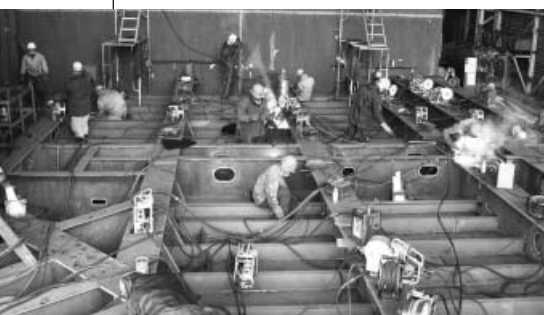
◎SF-1による甲板上での溶接状況
