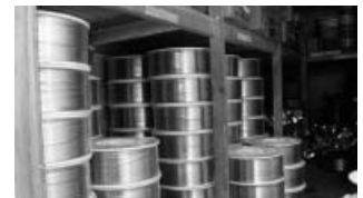
溶材保管倉庫。20キロ巻スプール製品が積まれている
