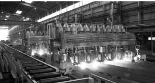
溶接状況と組立ブロックの例。溶材として◎SF-36E、◎SF-36Fが採用されている
