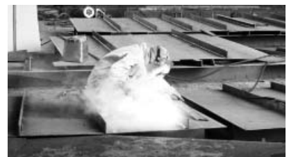
同社ではメインの溶材として◎SF-1が採用されており、高く評価されている(ワイヤ径1.2mm)
