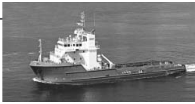
最近の新造船の例。(株) オフショア・オペレーション殿向け多目的アンカーハンドリング・タグ・サバイ船「かいゆう」。全長 62.40m、垂線間長さ 54.40m、幅(型) 14.00m、深さ(型) 6.00m、計画満載喫水 5.00m、試運転最大速度 13.8ノット(竣工 平成17年3月)
