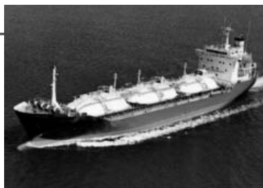
同社製の船用タンクを搭載したタンカーの実績例。 写真はLPG/VCMタンカー(6,540m 3 )
