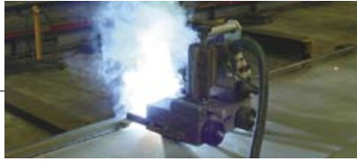
クレーン用ガーター部分の水平すみ肉溶接には当社小型軽量のNSキャリアオートが採用され、1人4台の同時操作が実施されている。溶接速度は1分当たり45cm
