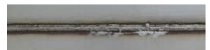
きれいに仕上げられている側板部分の溶接ビードの一例
