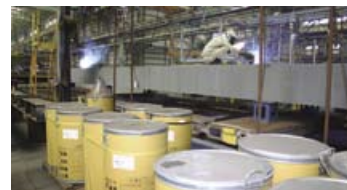
NSキャリアオートによる溶接にはSM-1Fの200kgパック(ワイヤ径1.2mm)が採用されている
