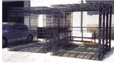
熊本工場の主力製品のひとつ、 ボックスカルパート用鉄筋金網
