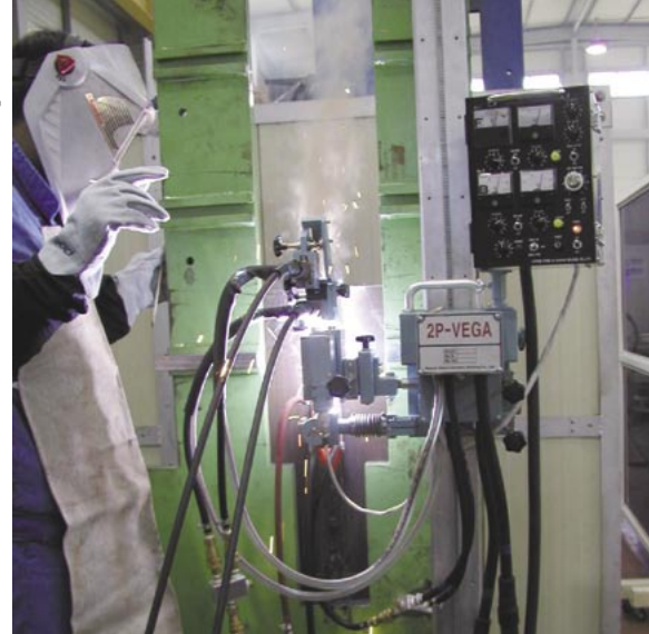
47キロ級高強度鋼板の溶接に適用される2電極 VEGA 法
