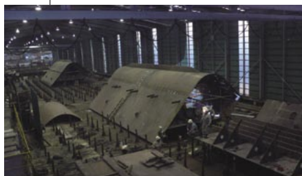
幅26m、長さ230mの造船ブロック専用組立工場の外観と内部。上屋部分は移動可能となっている。
