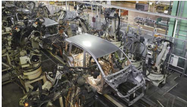
自動車工場における ロボット溶接ラインの一例 (写真：トヨタ自動車(株)殿提供)
