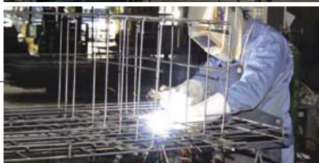
工場内のあちこちで、◎NS-03Tによる溶接がリズムカルにスピーディに行われている
