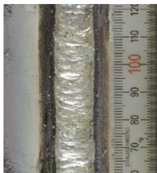
YAWATA WELD B(M)による立向上進(SMAW)
