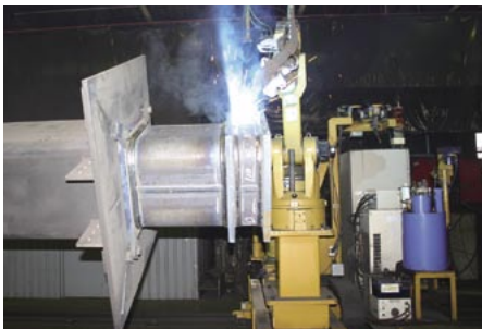
(上)溶接ロボットによる溶接状況 (下)角形鋼管継手の溶接ビード形状
