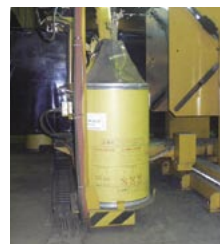
溶接ロボットに搭載されている◎YM-55C(R)。ワイヤ径1.2mm、300kgのストレートバックが採用されている
