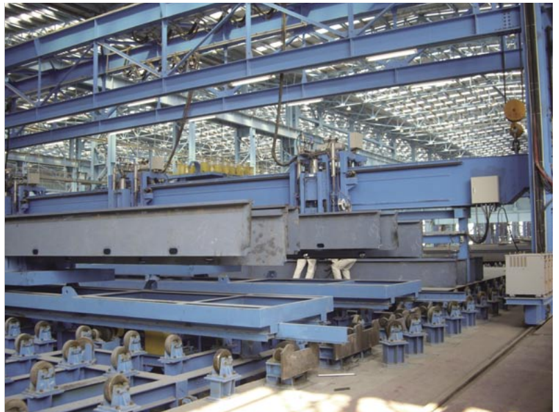
ロンジ配材・仮付装置
