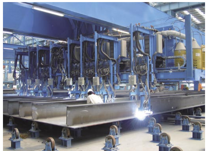
ロンジ溶接状況
