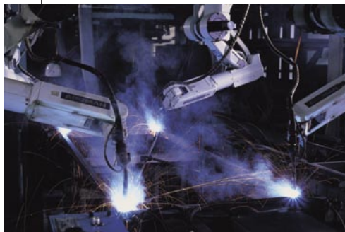
ロボットによる溶接作業の例
