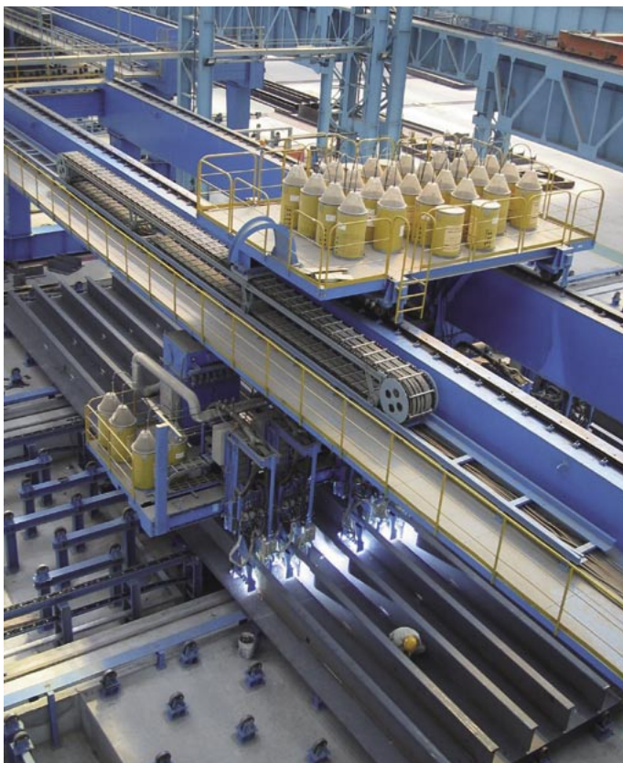
ロンジ溶接装置
