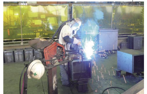
(上) ◎YM-55C (R) によるロボット溶接状況。ワイヤの性能が高く評価され、約1年前から本格導入され、夜間の無人操業も日常化している(ワイヤ径1.2mm、400kgパック)。(下) 手溶接には◎YM-55Cが採用されている(ワイヤ径1.4mm、400kgパック)
