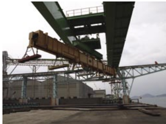
水深 7.5m の岸壁は物流面で大きな強み。写真は鋼材の水揚げ、製品出荷に活躍している旋回クレーン
