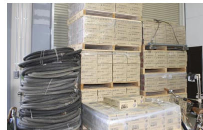
現場への搬出を控える◎YM-55Cの20kgスプール製品（ワイヤ径1.4mm）
