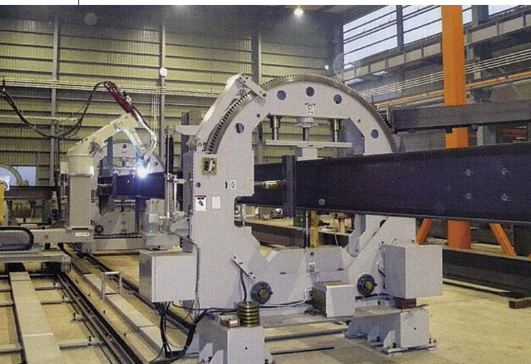
2007年10月に導入した大組用ロボット溶接機。溶材としてⓈYM-55C(R)が採用され、順調に稼働されている
