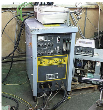
同社では交流にも対応可能なプラズマ溶接機NW-300ASRも導入されている
