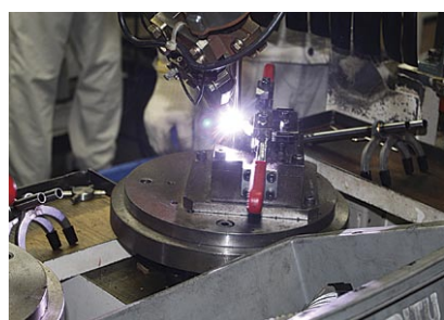
四輪マニュアル車用シフトフォークの溶接状況。プラズマロボット溶接機で製作されている部品として現在同社で最も量産されているもの
