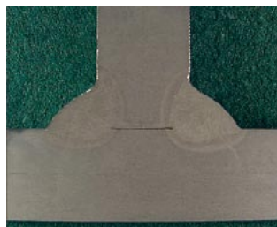
図3 ビード外観およびビード形状 (L極 430A-28V、T極 400A-34V、130cm/min、脚長6mm)
