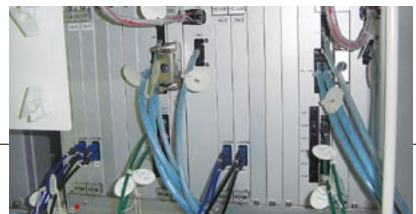
(左)ATC装置の一例。運転時短の短縮、多情報化対応、乗り心地の改善、運転手への支援情報の充実などを可能にしている装置 (右)ATS装置を組み込んだ電車の例。パターン制御、分岐部・曲線部での部分的な速度制限が可能でフレキシブルな速度対応を可能にしている
