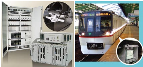
(左)ATC装置の一例。運転時短の短縮、多情報化対応、乗り心地の改善、運転手への支援情報の充実などを可能にしている装置 (右)ATS装置を組み込んだ電車の例。パターン制御、分岐部・曲線部での部分的な速度制限が可能でフレキシブルな速度対応を可能にしている
