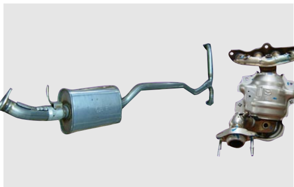
製造部品の一例(左・マフラー、右・エキゾーストマニホールド)
