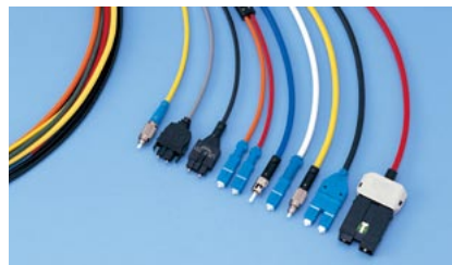
当社ピコフレキ。光ファイバをフレキシブルSUS管で保護し、両端に光コネクタを取り付けた屋内用光ケーブル。ネズミなどの獣害に強く、耐水性・耐熱性に優れ、インシュロックで強固に固定可能などの特徴がある
