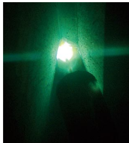
図6 立向上進溶接でのアーク状態
