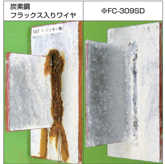
図2 溶接部の塩水噴霧試験結果 (JIS Z 2371 試験温度：35℃, 1,000hr)
