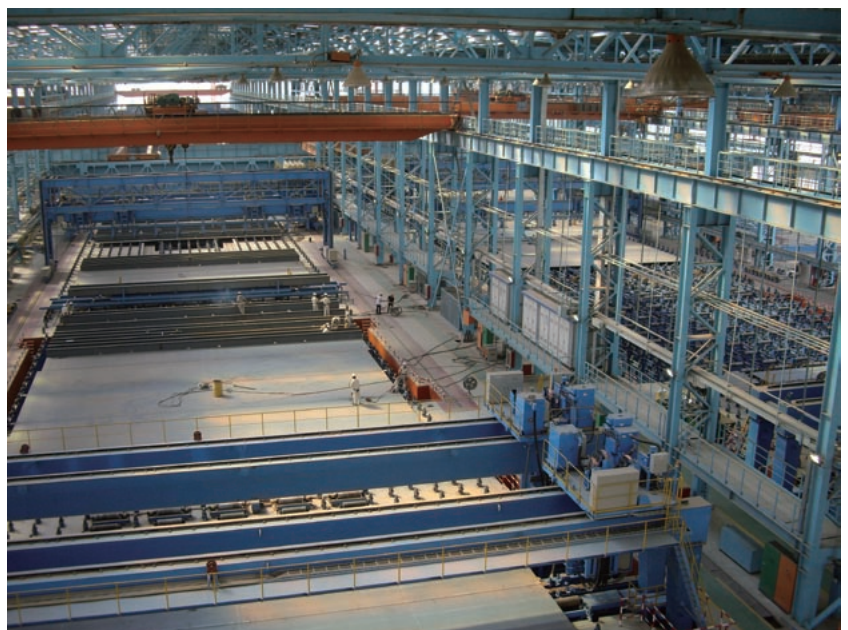
溶接設備建設・溶材供給・溶接指導の三位一体で取り組みを推進し、当社は中国向けに造船パネルライン設備の納入実績を重ねている。写真は実績の一つである、片面自動溶接装置
