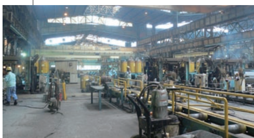
船殻工程ではビルトアップ製作ラインが3ライン設置されており、1日16時間体制で稼働中。本ラインでは◎FCM-1Fの500kgバック(ワイヤ径1.6mm)が採用されている。(上)ラインの稼働状況。(中)すみ肉溶接後の美麗なビード外観。(下)随所に◎FCM-1Fの500kgバックが置かれている。
