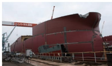
建造中の30万トン鉱石運搬船
