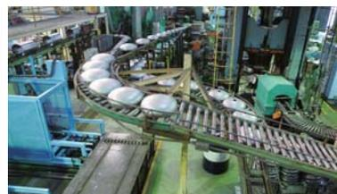
深絞り加工を経て胴体への溶接工程に進む鋼板
