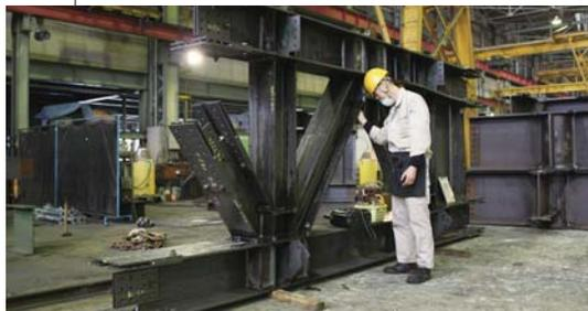
昨年4月から採用された ◎SM-1F による溶接状況(上)と、梁加工後の溶接部の検査業務の様子(下)
