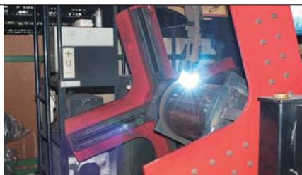
コア溶接中のロボット。ワイヤは ◎YM-55AG、径 1.4mm
