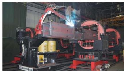
大組立溶接中のロボット。ワイヤは ◎YM-55AG、径 1.4mm。左奥に2台のバックを搭載した台車が見えている
