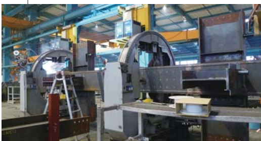
同社の独自開発になる半自動溶接機「ユニゴン」による溶接状況。◎YM-26 の 400kg バック(ワイヤ径 1.2mm)が採用されている。
