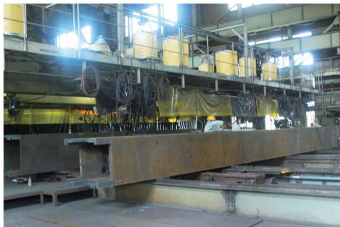
川田工業(株)では自社独自の横持ち方式ボックス柱製造ライン(特許)を含め、同社ならではの技術を發揮して建築鉄骨、橋梁など鋼構造物づくりに取り組まれている。
