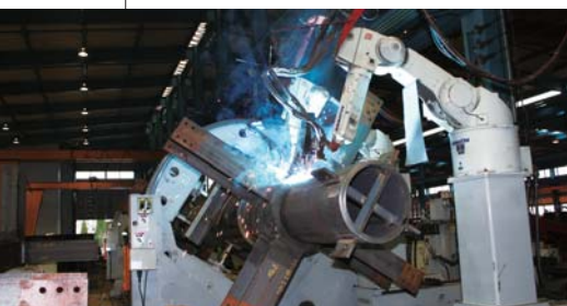
ロボット 2 台の組み合わせにより鋼管柱への部材を取り付けている溶接状況。◎YM-55C の 400kg バック(ワイヤ径 1.2mm)が採用されている。
