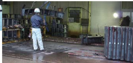
セグメント部材に止水性の確保は欠かせない重要課題。写真はカラーチェックなどを実施する検査場
