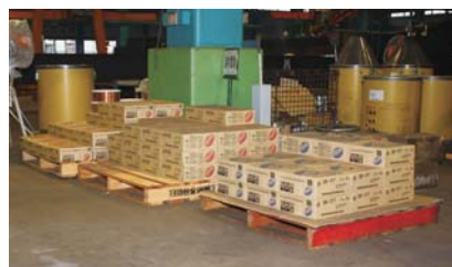
工場内の溶材置場の一例。手前に ◎SM-1FT が、奥に向かって ◎YM-55C、◎YM-26 などが置かれている。
