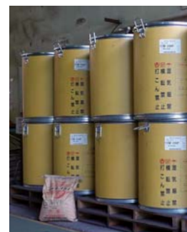
溶材置場の一例。ここではSESNET溶接機に採用されている◎YM-55HF(ワイヤ径1.6mm、350kgパック)とフラスクの◎YF-15Iが保管されている。
