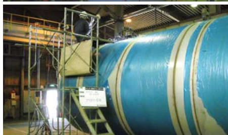
砂川工場におけるステンレスタン(SUS)の製作状況。直径2,900mm、長さ9,900mm、計8基がすでに出荷された。溶接には当社製プラズマ溶接機NW-350AHⅢが採用され、プラズマ溶接機ならではの多くの特色が発揮され、コストダウンの実現を含め、高く評価されている。(写真は同社提供による)
