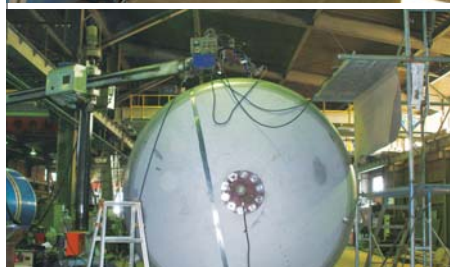
砂川工場におけるステンレスタン(SUS)の製作状況。直径2,900mm、長さ9,900mm、計8基がすでに出荷された。溶接には当社製プラズマ溶接機NW-350AHⅢが採用され、プラズマ溶接機ならではの多くの特色が発揮され、コストダウンの実現を含め、高く評価されている。(写真は同社提供による)
