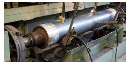
君津工場における肉盛溶接(サブマーシ)の例。このロールはCC(連続鑄造)用のロール
