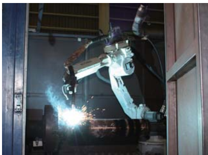
(左上) 木更津工場 CC ロールセンター内部。6ブースそれぞれに6軸多関節ロボットを用いたMAG自動溶接肉盛ラインを設置。オペレーター1名が6基を管理して効率生産を実現している(会社案内より)。 (右上) MAG自動溶接肉盛ラインによる溶接状況。溶接途中に必要となる溶接部のクリーニングも自動で対応している。 (左下) 硬化肉盛溶接を終えたCC用ロールの例(会社案内より)。
