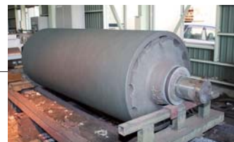
木更津工場で修復・再生中のシンクロール。これはCGL(連続亜鉛メッキライン)の亜鉛浴槽中に設置されるロールで外径800mm、長さ1,900mm
