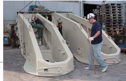
出荷前の目視検査状況
