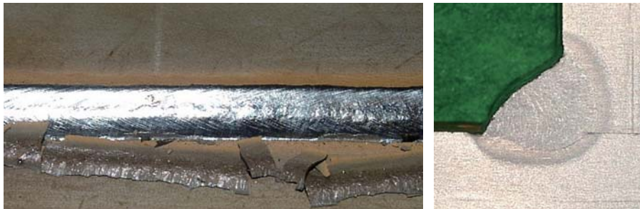
写真3 水平すみ肉溶接のスラグ剥離状態、外観およびビード形状
