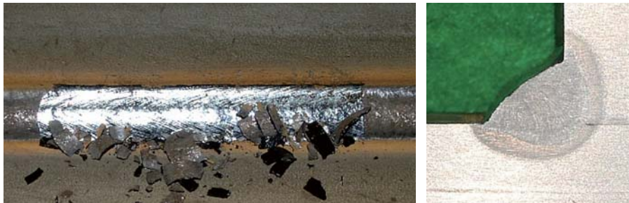
スラグ自然剥離タイプ：1.2mm 280A-40cm/min 脚長6mm
