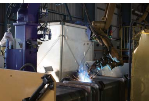
鉄骨溶接ロボット(瀬高工場)
