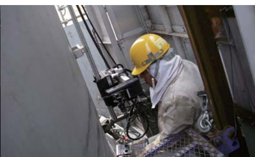
NAVI-21 適用状況(ステンレス鋼製タンク現地)
