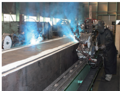
多層盛ウェルドランナーのボックス角溶接
