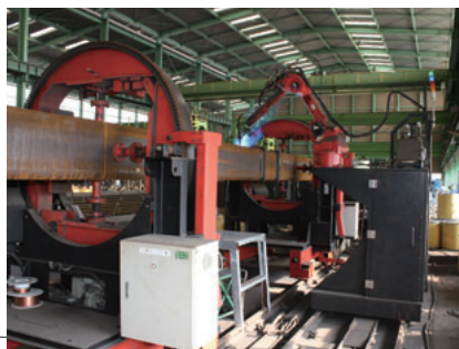
柱溶接回転設備
