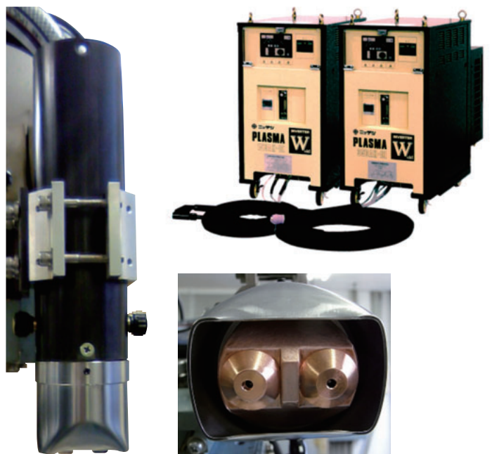
写真1 プラズマ溶接機と2電極プラズマトーチの外観
