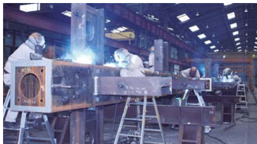
柱大組立溶接
