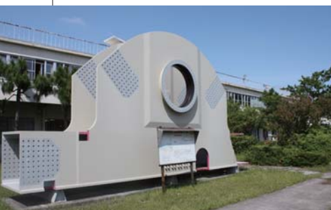
本州四国連絡橋／北備讃瀬戸大橋の下弦材実物大試験体
