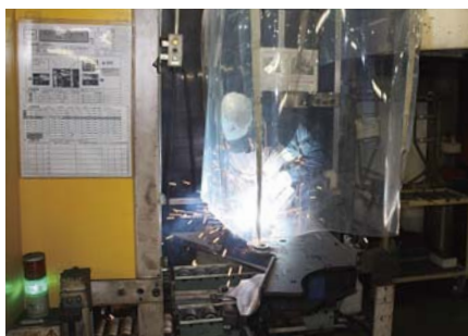
フレーム仮付けを3台完了すると、ロボット溶接したピラーの仕上げ工程に移動。作業は1台分当たり1.5分のスピード
