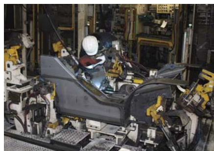
フォークリフトのフレーム溶接ライン前工程でサイドとリアのフレーム仮付けを1台分当たり3.5分でこなす
