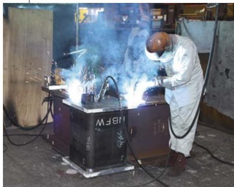
柱と梁の接合を簡易自走台車と半自動で同時溶接し高能率化を図っている。ワイヤは ☉YM-55C(Y)
