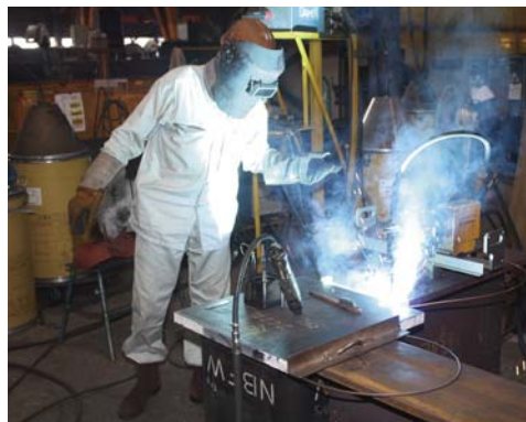
柱と梁の接合を簡易自走台車と半自動で同時溶接し高能率化を図っている。ワイヤは ☉YM-55C(Y)
