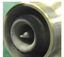
100回溶接後 (条件: 160A、100cm/min)
