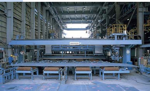
板継SAW溶接装置
