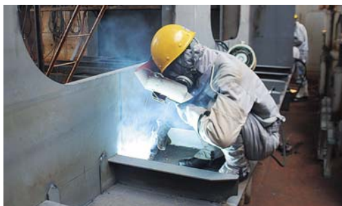
◎SF-1による溶接状況
