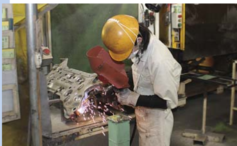
エンジンマウンティングの仕上げ手溶接
