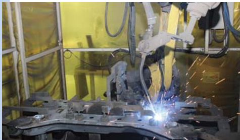
多軸ロボットを使用した CO 2 溶接
