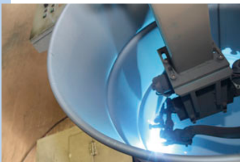
特殊ドラム缶の胴体と底板(地板)の側周折曲げ部を内側から溶接
