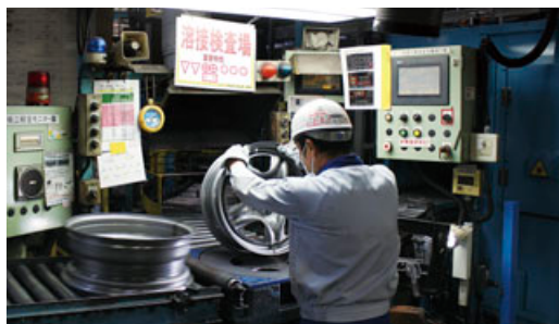
後工程に100%良品を流すため溶接検査場で徹底したチェックを行う
