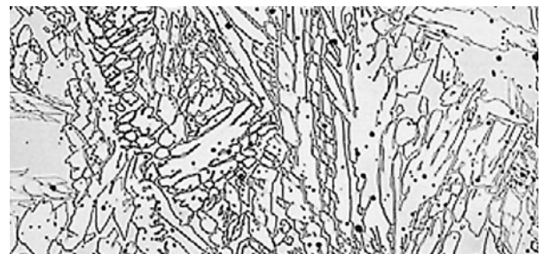
写真1 溶接部の金属組織の一例
