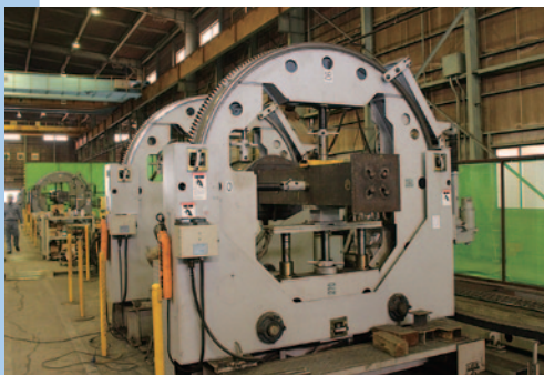
柱大組溶接ロボット
