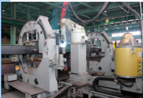
柱大組溶接口ボット
