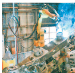
溶接ロボット(台車枠用)
