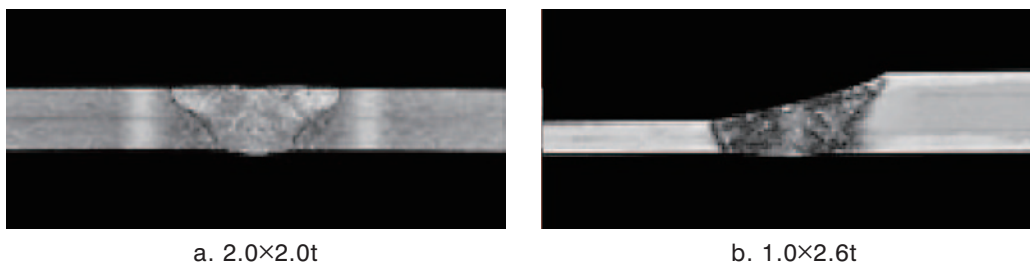
図9 プラズマアーク溶接でのテーラードブランク溶接の断面マクロ
