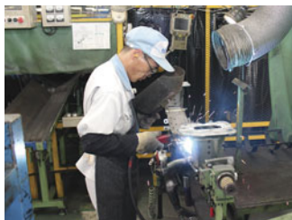
検査時の手溶接風景 三十数カ所に及ぶ溶接品質検査を瞬時にし、調整が必要な場合に技能者が手直しする。
