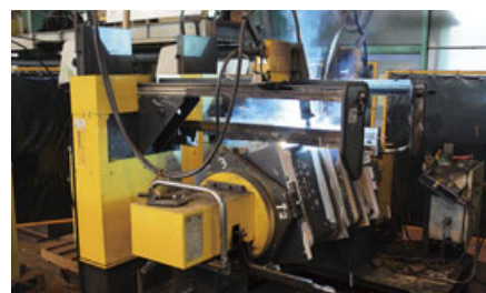
仕口溶接ロボット
