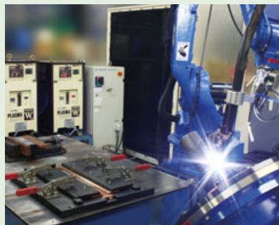
プラズマ溶接機ならびにプラズマサンプル作製場面
