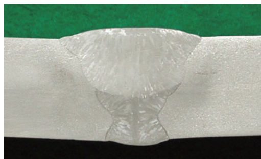
図 8. ステンレス鋼の立向上進溶接例
