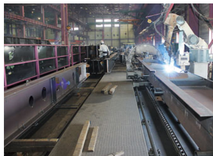
梁溶接ロボット
