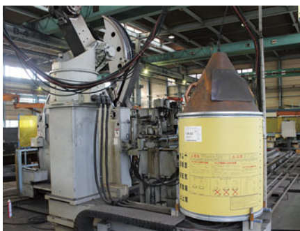
仕口溶接ロボットに使われているYM-55C(泉沢工場)
