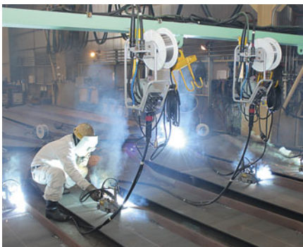
ホールドフレームの10連自動溶接
