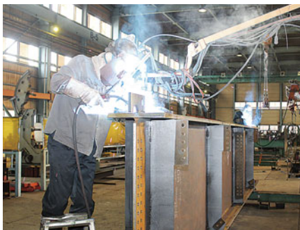
上写真2枚ともソリッドワイヤによる半自動溶接(泉沢工場)
