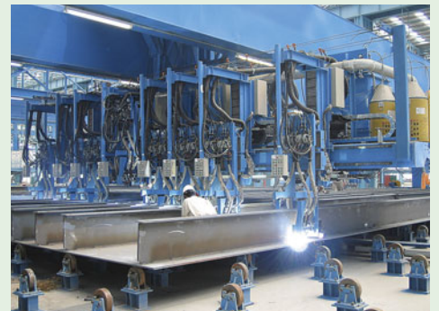
造船におけるロンジ溶接装置
