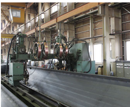
サブマーシブ板継溶接
