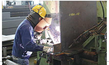
ビルトH仮溶接
