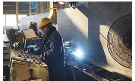
ビルトH組立溶接
