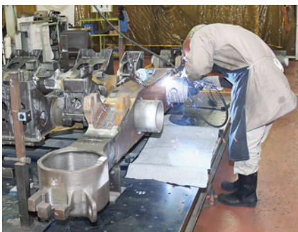
台車枠組立仮溶接
