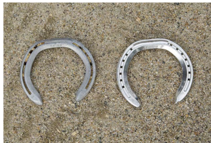
使用後の摩耗した蹄鉄(左)と使用前の蹄鉄
