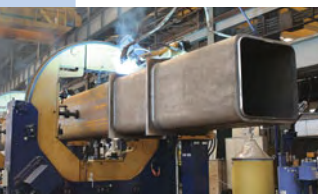
柱大組立溶接口ポット2アーク式
