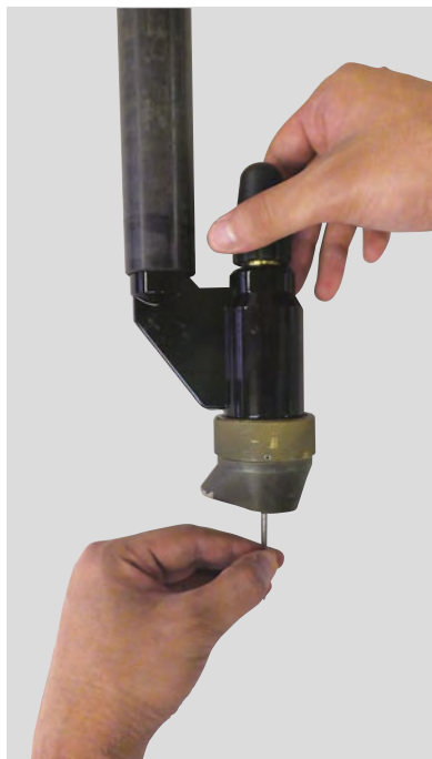
写真1 電極棒交換風景
