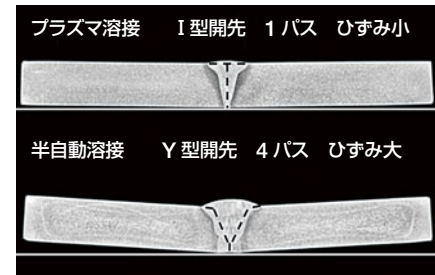
写真3 プラズマ溶接と半自動溶接のひずみ量比較
