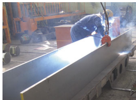
小型立旋盤用クロスレールのすみ肉溶接
