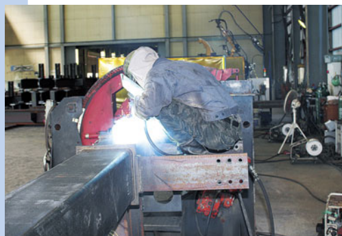
立体駐車場用柱プレート溶接
