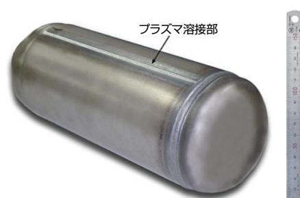
写真 6 エアコン用圧縮器のプラズマ溶接例
