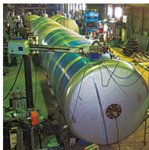
写真 5 大型ステンレスタンクのプラズマ溶接例
